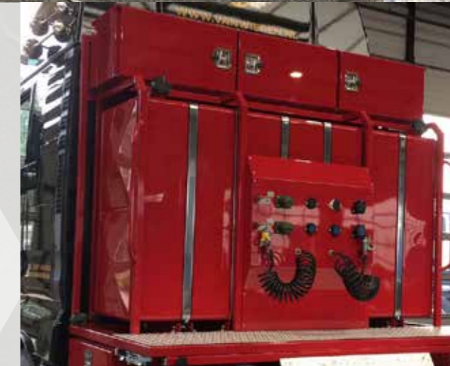
▶ RVS kistenwand inclusief 1400 liter brandstoftank
