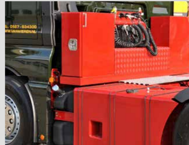
▶ RVS kistenopbouw inclusief accubak
