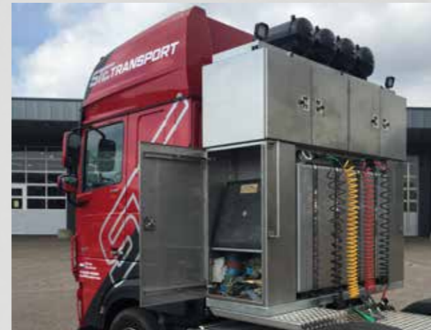
▶ RVS kistenwand inclusief 1050 liter brandstoftank
