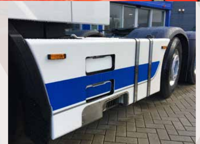
▶ Brandstoftank met optische verlenging in vorm van het voor- en achterspatscherm
