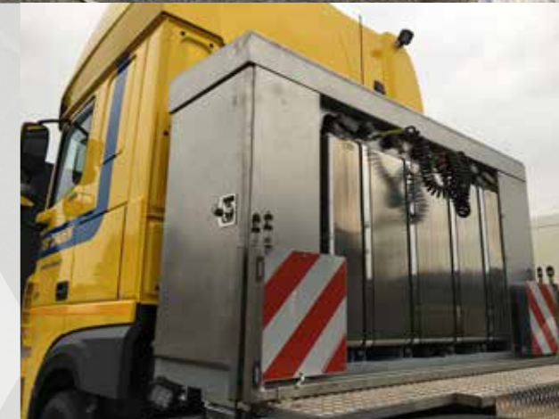
▶ RVS kistenwand inclusief 820 liter brandstoftank
