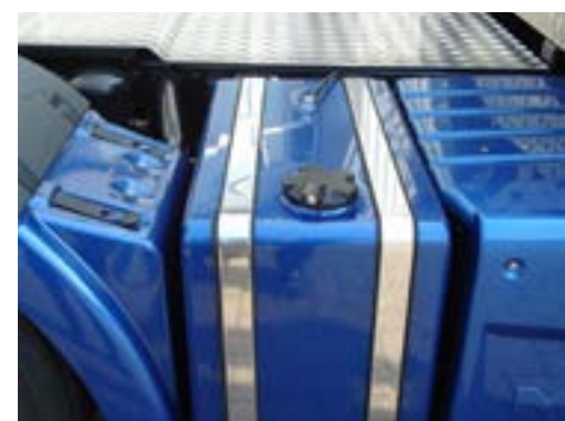
Midden: Optie 1 met verplaatste Adblue Onder: 195l brandstoftank
