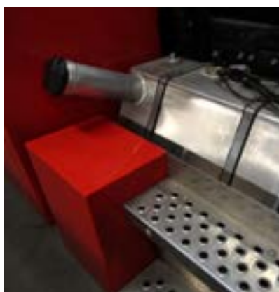
Links: Speciale brandstoftank voor brandweervoertuig Rechts: Hydraulische tank
